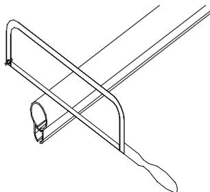
Faire une tresse dans la maille au point où on veut placer le poteau. Faire une encolure semblable à celui d'autres poteaux en coupant soigneusement le jonc soudé en haut et en bas.
