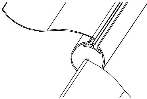
Pour assembler deux modules, il faut introduire le jonc soudé en extrémité de toile dans la rainure restée libre du premier poteau du module suivant.
