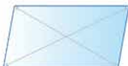
Diagonales avec écart supérieur à 5 cm
